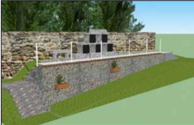
Le projet consiste à aménager le tour du columbarium, pour le mettre en valeur et sécuriser son utilisation. Un mur de soutènement a été monté avec des gabions (cages en acier remplies de pierres) et deux escaliers en béton seront construits pour l'accès.
